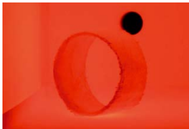
Guaina termoindurente sottoposta a temperature forzate in un forno
